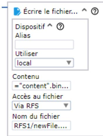
**Contenu :** Spécifiez une variable binaire contenant des données à écrire dans le système de fichiers du robot. Dans cet exemple, le « contenu » est la chaîne de caractères écrite dans le fichier. Le contenu du fichier doit être binaire.
