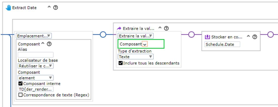
Le champ Composant interne est utilisé pour rechercher des composants dans le composant de tableau déjà trouvé, et contient l'élément de tableau de niveau inférieur suivant : TD[headers="jem\_date"]. TD signifie « table row » (ligne de tableau).
